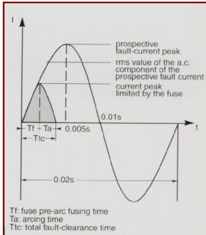
Esta limitación de corriente reduce significativamente los esfuerzos térmicos y electrodinámicos, disminuyendo de esta forma los peligros y daños para las corrientes de cortocircuito elevadas.
