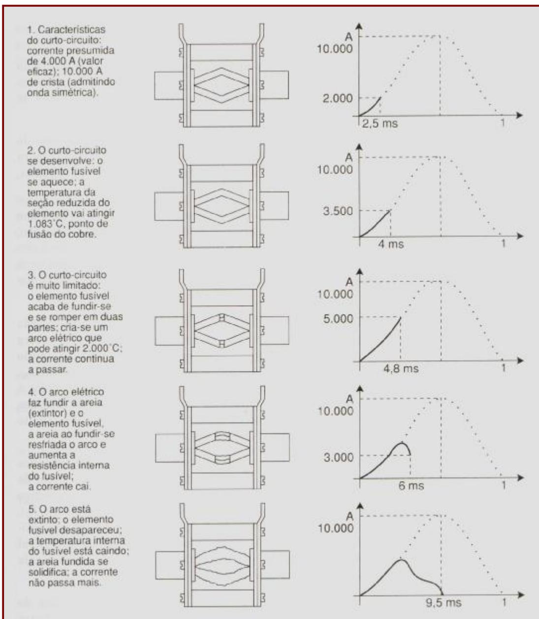
Luego de la fusión el elemento fusible, la corriente continua circulando por un tiempo a través del arco mantenida por la fuente y por la inductancia del circuito. El arco vaporiza el elemento fusible y el metal vaporizado a alta presión es empujado contra la arena donde se produce finalmente la extinción del arco.
