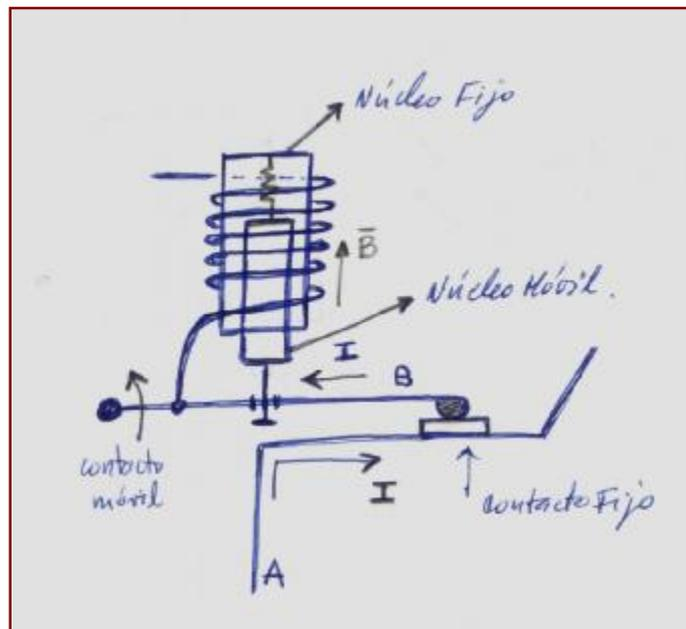
En el caso que la corriente de disparo magnético sea regulable, en unidades de disparo termomagnéticas el ajuste se realiza por la variación del entrehierro o de la tensión del resorte. El disparo magnético puede ser instantáneo (cuando no existe ninguna temporización intencional) o temporizado.
