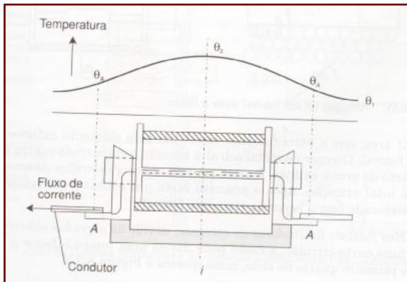
La temperatura en los puntos de conexión al conductor ( $\theta_A$ ) no debe superar un valor determinado para no perjudicar la vida útil del aislamiento del cable, este valor es limitado por la norma.
