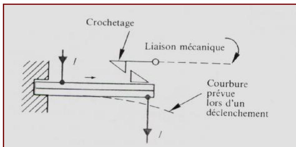
La regulación de la corriente de disparo térmico en este tipo de interruptores termomagnéticos, es actuando sobre la curvatura de las láminas. Para los interruptores automáticos del tipo caja moldeada las unidades de disparo térmico son reemplazables.
