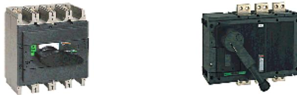
Es un dispositivo en general operado manualmente (aunque puede disponer de disparo eléctrico) y tiene dos posiciones cerrado-abierto. Está diseñado para cerrar o abrir circuitos en carga en condiciones normales de servicio (sin falla) y por lo tanto se le asignan corrientes nominales de cierre y apertura para las condiciones normales de servicio.
